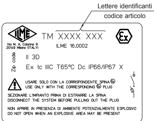
Figura 2 – Targhe utilizzate per prese interbloccate serie TM-Ex versioni da quadro, con fusibili.
